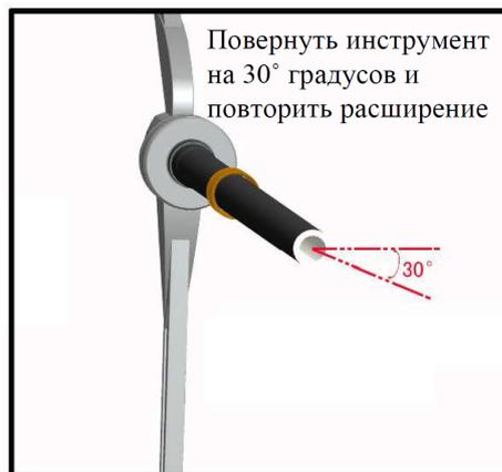
**Внимание:** нет необходимости производить расширение более чем два раза. Чрезмерное или недостаточное расширение трубы может привести к возможной протечке соединения.
