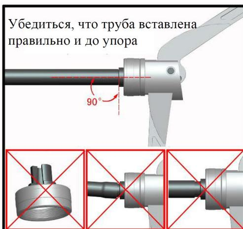
4. Чтобы произвести расширение трубы, полностью сведите рукоятки расширительного инструмента. Задержите их в нужном положении, затем отпустите и поверните инструмент примерно на 30° (труба остается в исходном положении) и повторите процесс. Это гарантирует равномерное расширение внутренней поверхности трубы.
